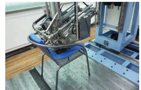
性能試験は、国内ではJIS規格に従って実施しています。試験項目を「合格」
